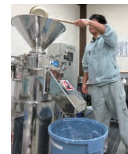
パルプからセルロースナノファイバーを調製している様子 Preparation of cellulose nanofiber from pulp using a grinder
