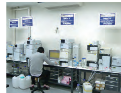
様々な希少糖類の分離・同定に使用しているHPLC システム HPLC system for the separation and identification of various rare sugars
