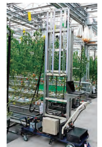
植物診断のためのクロロフィル蛍光画像計測ロボット(プロトタイプ) Chlorophyll fluorescence imaging robot for plant diagnosis (Prototype)
