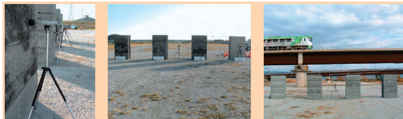
ポラスコンクリートの騒音低減効果に関する調査研究 Field research on reduction effect of traffic noise by the porous concrete
